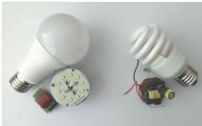
Sl. 1. Izgled LED i CFL sijalice i njihovih sastavnih dijelova
