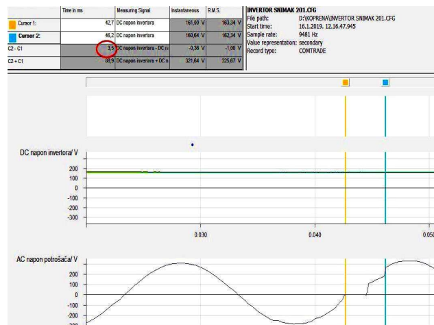
Сл. 8 Детаљан приказ пропада напона на AC потрошачу са табеларним приказом времена трајања пропада
