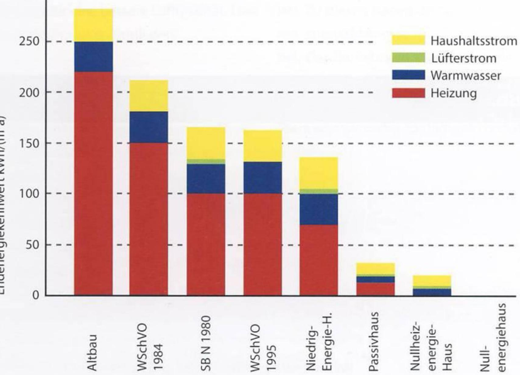
Abbildung 1: Endenergiemengenwert und Verteilung des Energieeinsatzes
