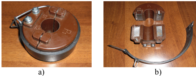
Sl. 13 Obuhvatni strujni merni transformator X/1 A: a) zatvoren; b) otvoren
