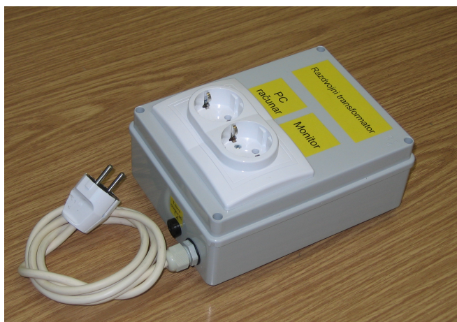
Sl. 17 Razdvojni transformator za napajanje PC računara i monitora
