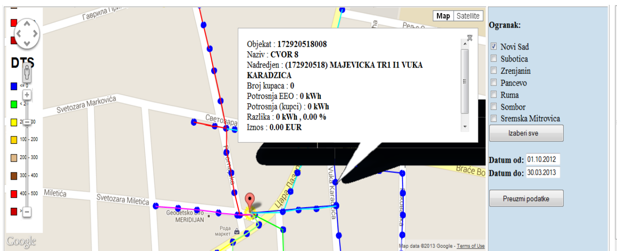
Sl. 10 Prikaz osnovnih karakteristika izabranog čvora NN mreže
